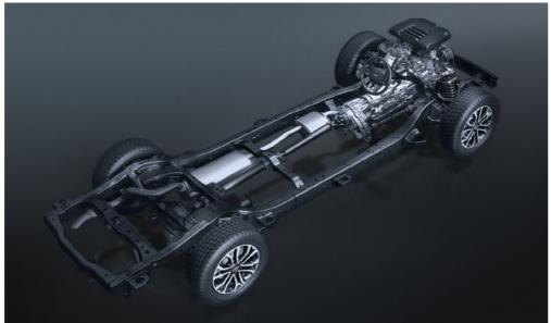
Рамная конструкция кузова
